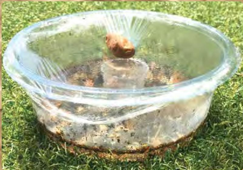
水的蒸馏是将水从其他物质（不易挥发的物质）中分离出来的最古老的方法。太阳光线使水蒸发（这是一个缓慢的过程，但15分钟内你就能观察到变化）。水蒸汽会上升，当它们碰到保鲜膜时，它们开始凝结并滴入杯中。石头造成的凹陷有助于把水引导到杯子里。由于只有水被蒸发了（泥土、石头、树叶等则不会），我们最终获得了干净的水。
