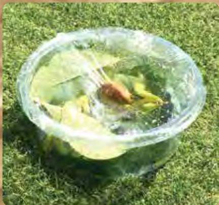
植物细胞含有水分（约80%）。当我们把新鲜的叶子放在阳光下，叶子上的水就会蒸发，当水蒸汽碰到保鲜膜时，它们会聚集成水滴，最终由于石头形成的小凹陷滴入杯子。积聚在杯子里的水经过蒸馏后变得洁净。
