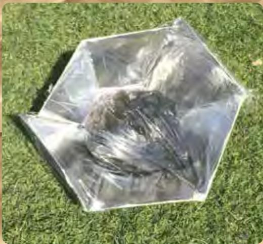
太阳能灶（Solar Stove）使用太阳的能量（sol在拉丁语中的意思是太阳）来做饭或加热东西。在温暖的地方，特别是没有电的偏远地区或者野外生存环境中，这会是一个非常方便的发明。太阳能灶的工作原理是搭建一个能聚焦太阳光的盒子。当太阳照射到盒子时，它被吸收并转化为热能。为了增加吸收量，我们使用铝箔作为一面镜子，帮助光线直接射入盒中。黑色餐巾能有效吸收光线并将其转化为热能，从而提高太阳能灶的性能。保鲜膜封住了太阳能灶，防止热量散失。我们使用保鲜膜是因为它是透明的，可以让光线穿透到太阳能灶。
