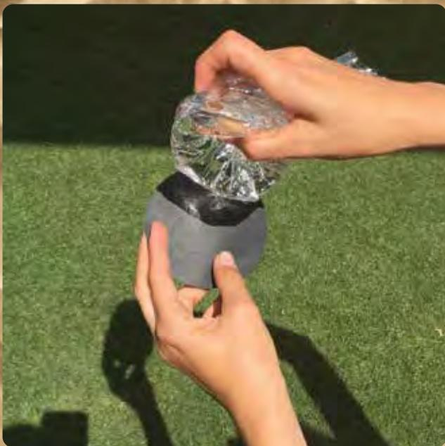
透镜是一种聚焦光的装置。由于其弧形的形状，导致进入的光线折射并改变了方向，因此透镜成功地对光进行了聚焦。弧形的形状使光线照射到透镜上聚焦到一个称为“焦点”的点上。从焦点发出的热量非常强大。透镜可以由多种材料制成：玻璃、塑料，甚至水，只要它们是透明的，并且有正确的弧度。在这个实验中，圆形的袋子帮助我们将太阳光聚焦到一个点，使温度升高到足以引燃火。
